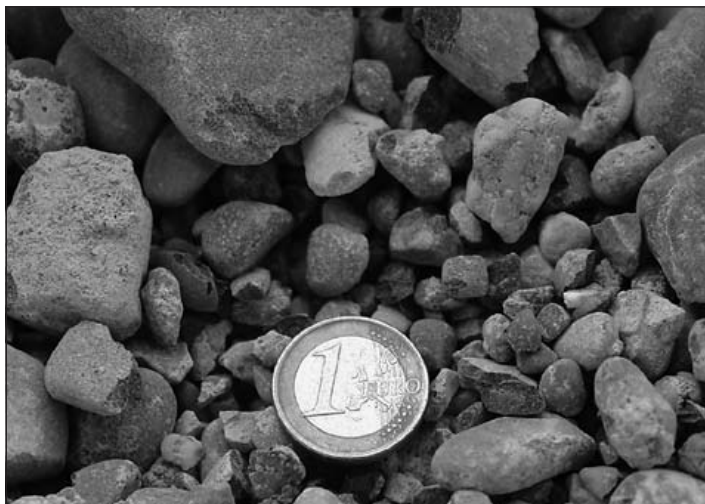
Abbildung 7 Mittels elektrodynamischer Fragmentierung (Selfrag-Verfahren) zurückgewonnener Kies aus Beton
